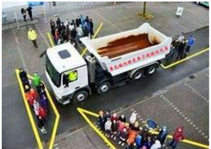
< 圖七：大型車視野死角示意圖 >
