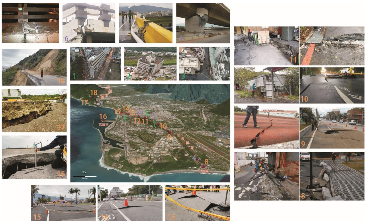
圖10. 0206花蓮地震主要破裂/破壞位置分布圖（底圖：Google Earth）
