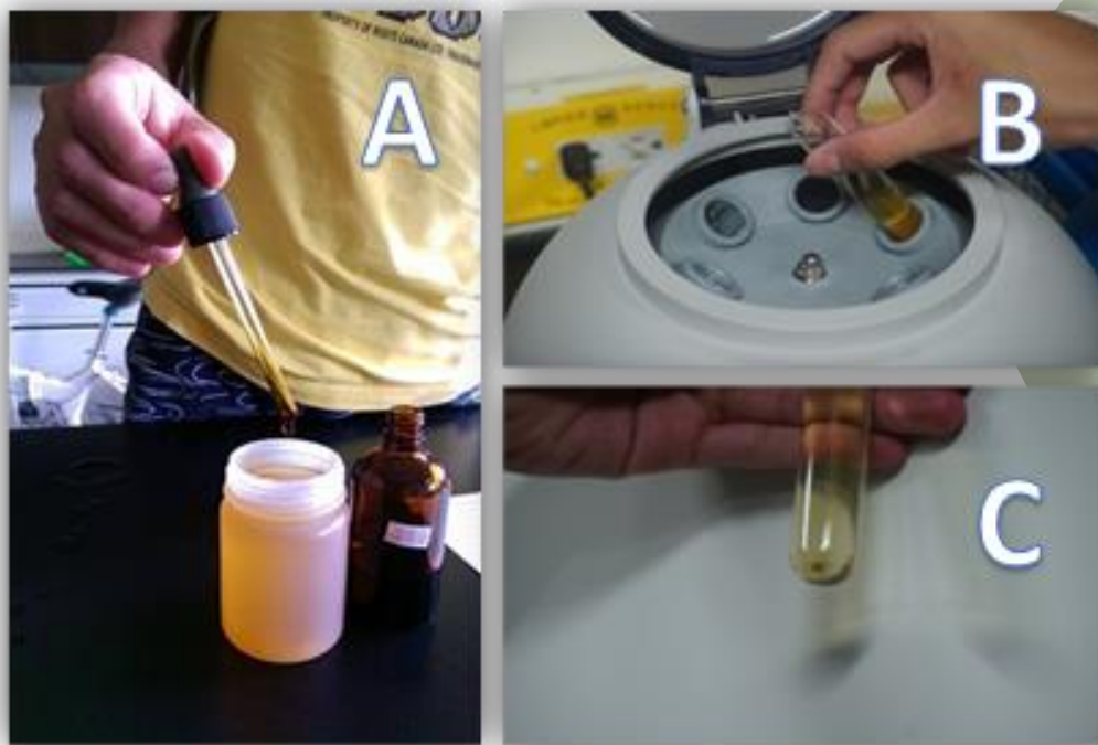
圖三、水樣處理程序（固定、離心濃縮）
