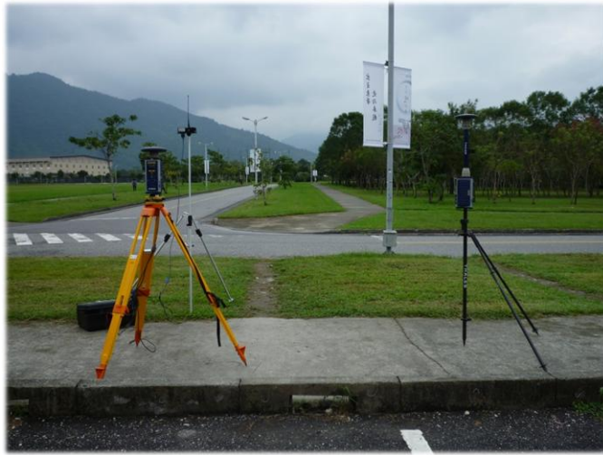
圖二 即時動態全球衛星定位系統(RTK-GPS):左為主站(包括控制器與UHF發射天線)，右為移動站(包括控制器與UHF接收天線)
