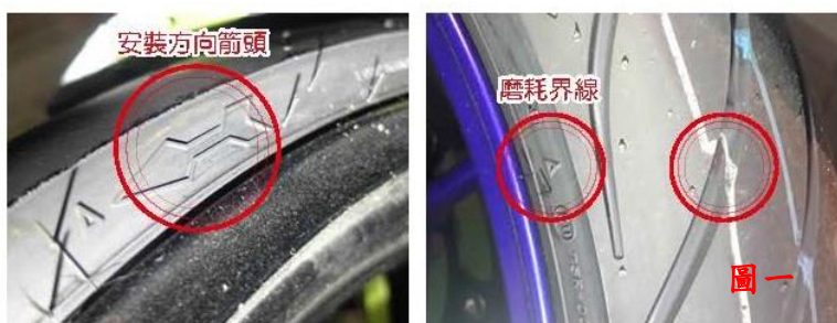
圖一： 每條輪胎都會設置輪胎磨耗警示點，務必定期查看胎紋深度是否足夠，若胎紋深度已到達磨耗界線，表示輪胎已經沒有足夠的排水效用，應予以更換。
